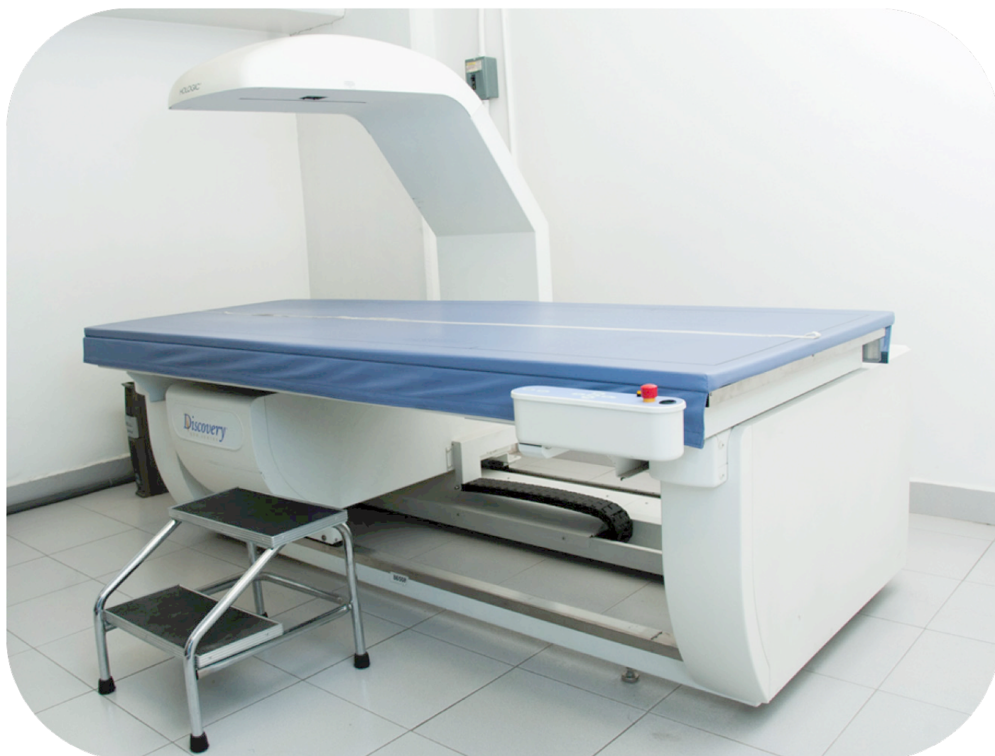
Equipo Absorcimetría Dual de Energía de Rayos X para evaluar la composición corporal
