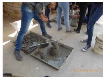
Prueba de revenimiento
