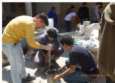
Colado de cilindros
